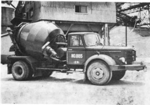
生コンミキサー車（ロケット型3m<sup>3</sup>積）
